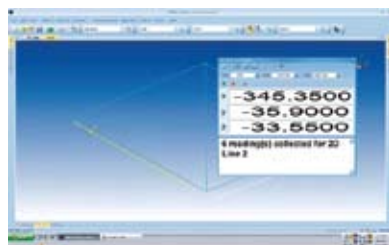
1. Измерение опорных элементов и выполнение «базирования по детали».
